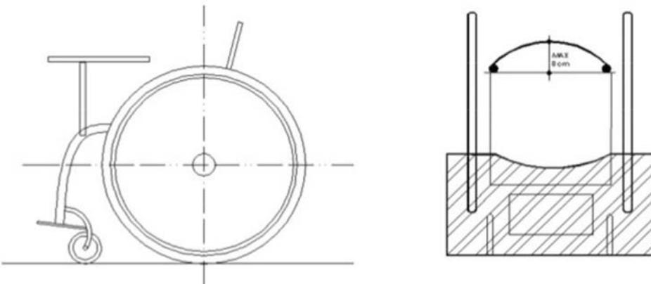
2. Der Schießtisch muss horizontal, oder im gleichen Winkel vom Mittelpunkt des Tisches gemessen, wie der Boden sein. ( $\pm 5^\circ$  sind erlaubt)
