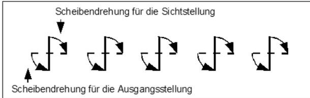
Die Zeit für die Drehung der Scheiben um 90° darf bei automatischen Anlagen höchstens 0,2 Sekunden betragen.
