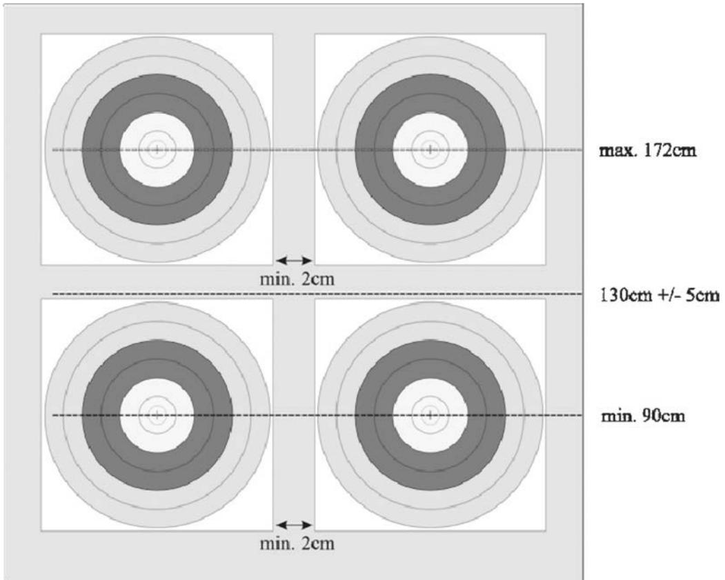
Anordnung der Auflagen bei der Verwendung von vier und drei senkrecht angeordneten 40-cm-Dreifachauflagen:
