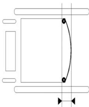
Das Spannungsmaterial der Rückenlehne darf sich, gemessen von der Vorderkante der vertikalen Seitenrohre der Rückenlehne bis zur tiefsten Stelle der Rückenlehnenbespannung nicht mehr als 8 cm durchdrücken. Dieser Abstand ist zu messen, während der Schütze in Anschlagsstellung im Schießstuhl sitzt.
